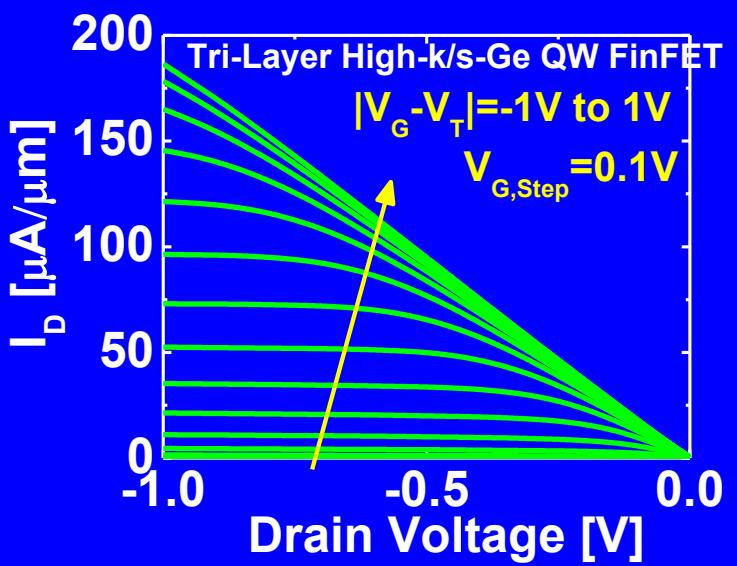
$W_{\text{fin}}=20\text{nm}; L_G=100\text{nm}; 10 \text{ fins}/\mu\text{m}$
