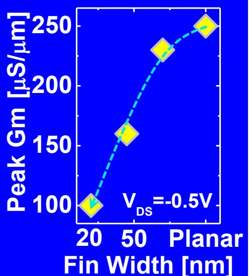
$W_{fin}=20\text{nm}; L_G=5\mu m; 10 \text{ fins}/\mu m$
